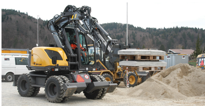
Als Lader schafft der Mecalac 714MWe mit der Palettengabel bis zu 2.2 Tonnen.
