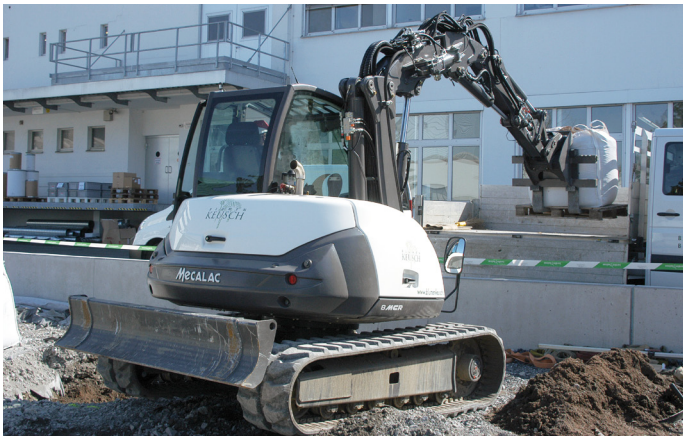
Der Mecalac 8MCR erledigt alle gängigen Arbeiten eines Laders, Baggers und Transporters. Hier beim Entladen eines LKW's.
