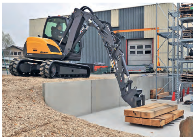
Ladearbeiten mit der Palettengabel und einer Reichweite bis zu 6.70 m
