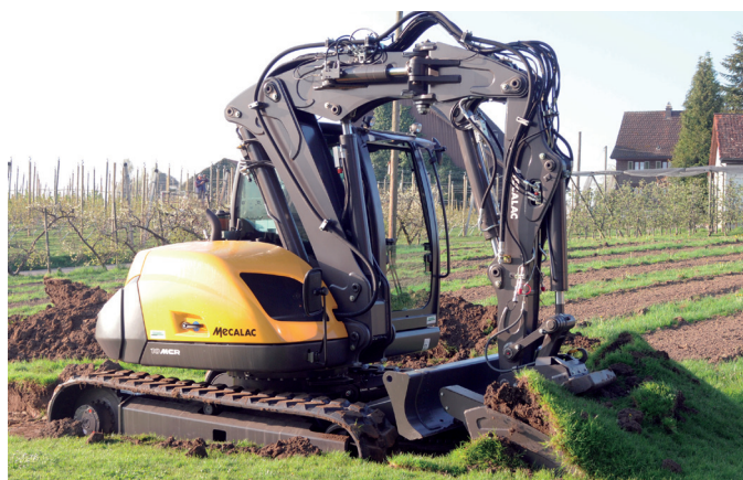
In der Testwoche überzeugt und in der Praxis bestätigt: Der Mecalac ist auch beim Humusabstossen einmalig. Mit seinen 75 PS, den zwei Fahrpumpen und der Schubkraft von 5400 daN wird die Kraft beim 8MCR über den Schild direkt auf das Fahrwerk geleitet.
