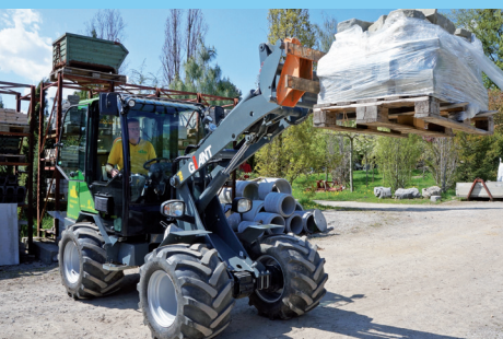
Mit seiner Hubkraft von 2920 kg transportiert der Giant schwerste Steinpalette in einem Wisch
