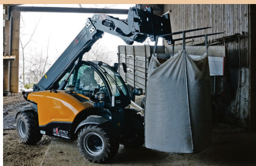
Transportfahrten mit Big Packs im Gelände und ihr Handling in niedrigen und hohen Räumen sind mit dem Giant einfach und sicher möglich
