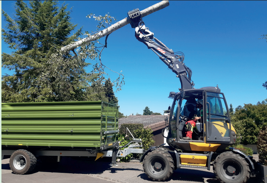
Im Vergleich zu einem Lieferwagen mit Anhänger kann mit dem Mecalac Mobilbagger 7MWR und dem Dreiseitenkipper die doppelte Nutzlast und das dreifache Volumen transportiert werden.
