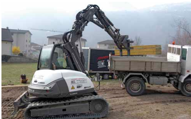
Der Allrounder 8MCR bei typischen Ladearbeiten mit der Palettengabel.
