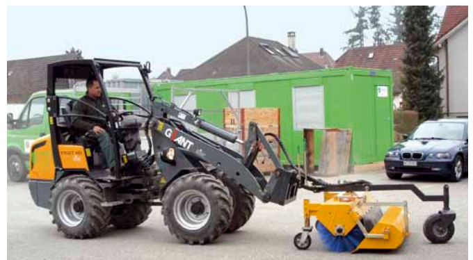
Auf den Baustellen wie im Werkhof kann der Giant V452T HD sehr vielseitig eingesetzt werden, wie zum Beispiel als Putzmaschine.
