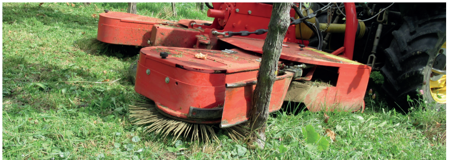
Mit dem Humus Sichelmulchgerät AF2000/2 wird der Unterstockbereich der Rebe dank elektrohydraulisch gesteuerten Tastarmen schonend und praktisch rückstandslos ausgemäht.
