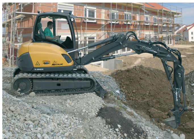
Der dreiteiligen Verstellausleger des Mecalac 8MCR gräbt bis 3.70 m Tiefe.
