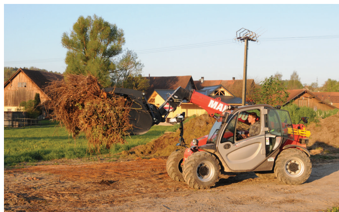
Der Manitou MT 625 im Einsatz mit einer Multifunktionsgreifschaufel
