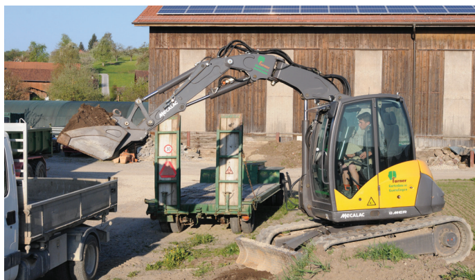
Der 8MCR hebt die 0,5 m 3 bis zu einer Ausschütthöhe von über 5 m.
