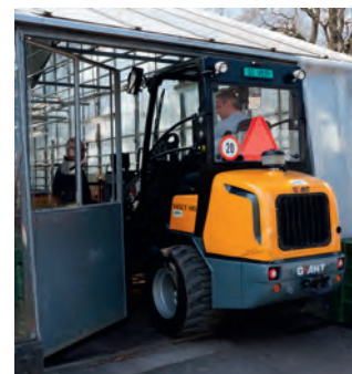
Das tiefer gesetzte Dach erlaubt die Einfahrt in alle Gewächshäuser
