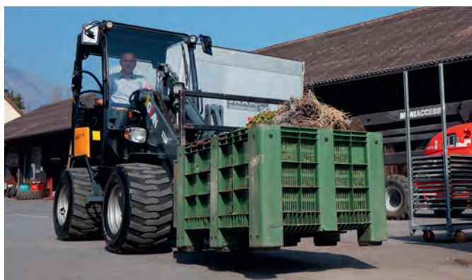
Ein breites Rad verschmutzt die Umgebung weniger als Zwillingerräder
