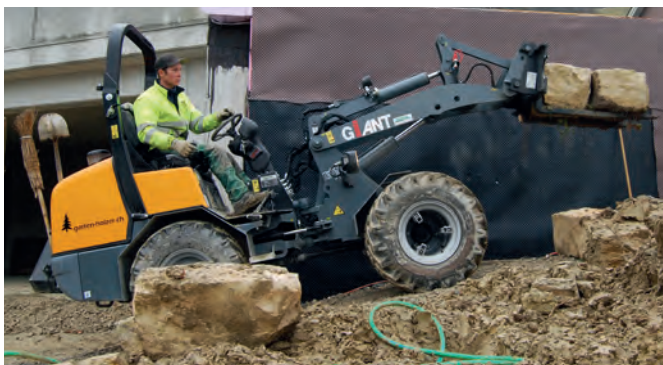
Mit 1.8t Hubkraft sind beim Heben kaum Grenzen gesetzt
