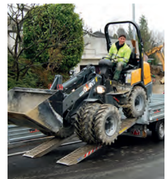
Der V452T HD ist problemlos und schnell mit dem 3.5-Tonnen Anhänger transportierbar
