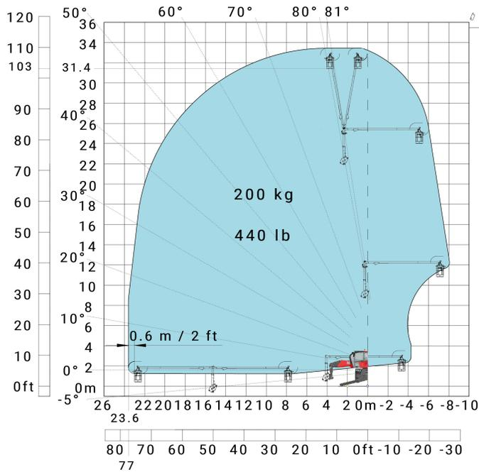
Drehung mit abgesenkten Stützen mit 3D negativ
