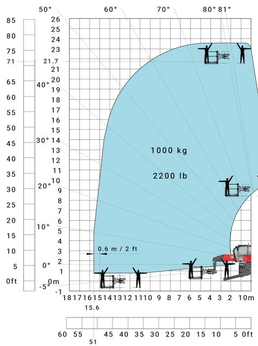
Drehung mit abgesenkten Stützen mit 3D positiv
